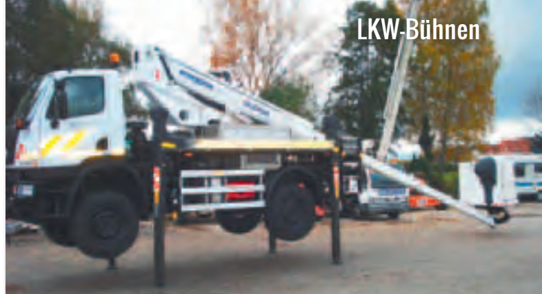
Oil&Steel baut seine Scorpion mit 18 Metern Arbeitshöhe auch auf Unimog auf
