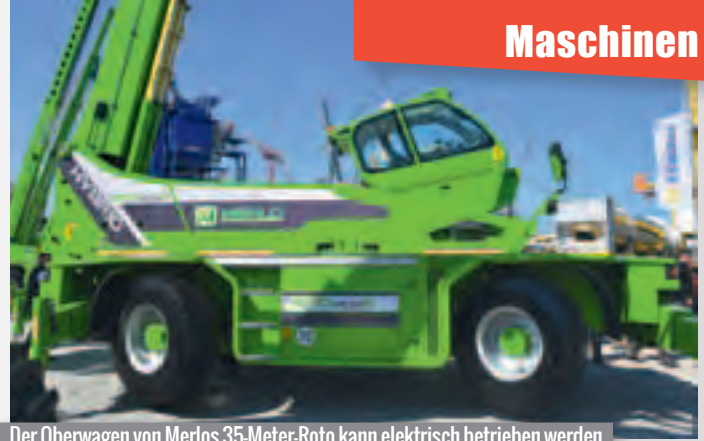
Der Oberwagen von Merlos 35-Meter-Roto kann elektrisch betrieben werden
