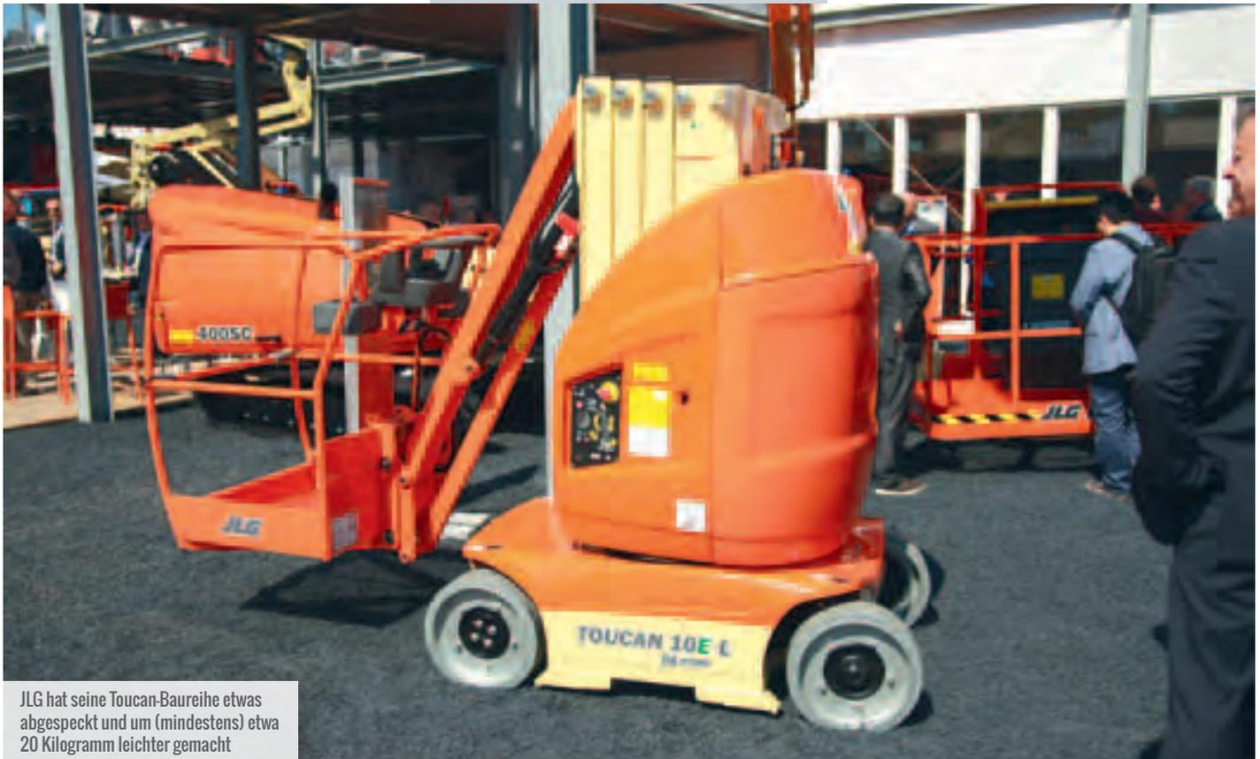
JLG hat seine Toucan-Baureihe etwas abgespeckt und um (mindestens) etwa 20 Kilogramm leichter gemacht
