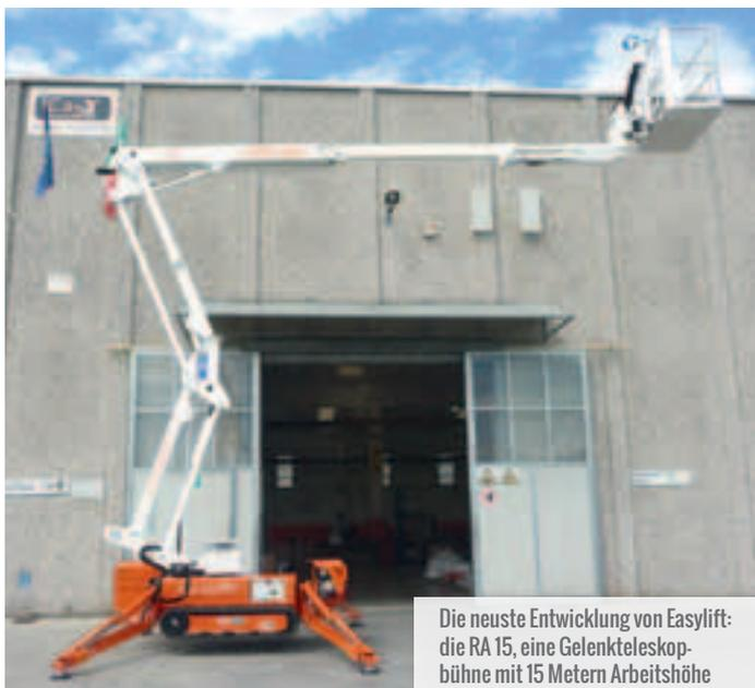
Die neueste Entwicklung von Easylift: die RA 15, eine Gelenkteleskopbühne mit 15 Metern Arbeitshöhe
