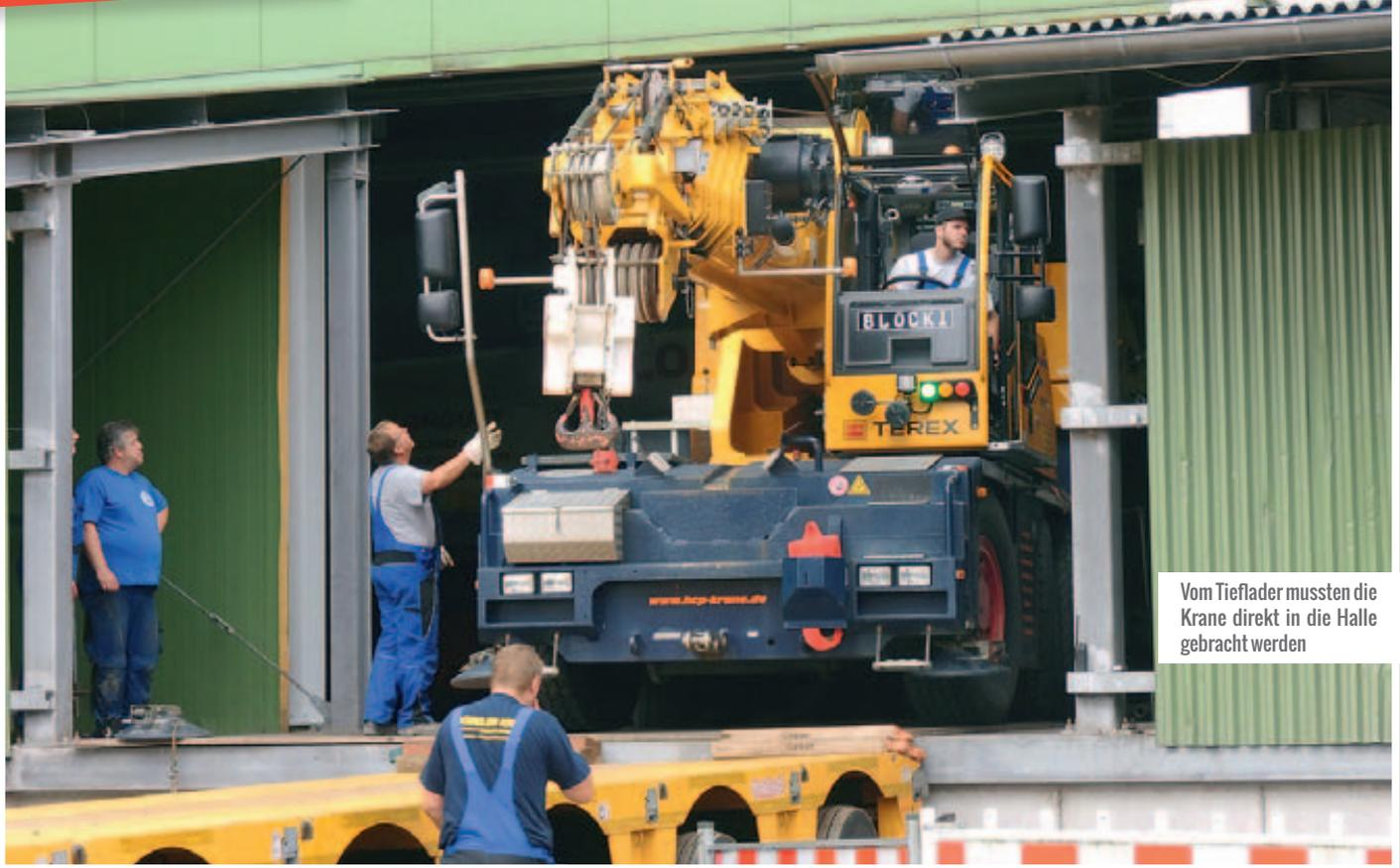
Vom Tieflader mussten die Krane direkt in die Halle gebracht werden
