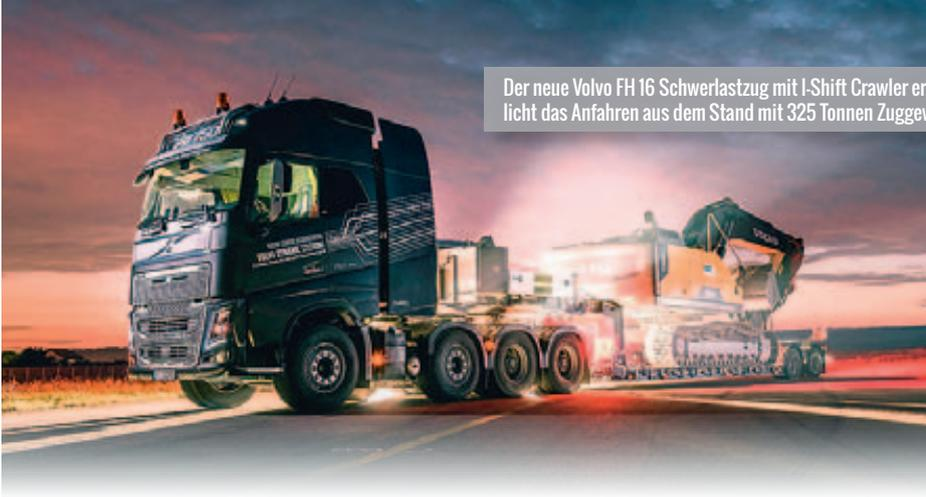
Der neue Volvo FH 16 Schwerlastzug mit I-Shift Crawler ermöglicht das Anfahren aus dem Stand mit 325 Tonnen Zuggewicht
