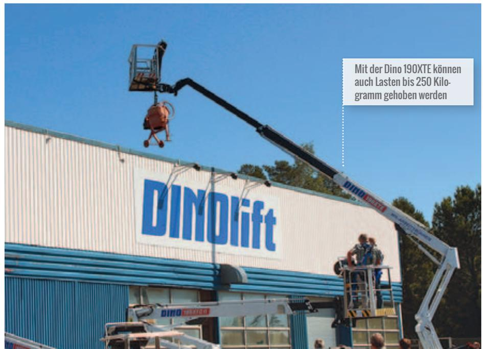
Mit der Dino 190XTE können auch Lasten bis 250 Kilogramm gehoben werden
