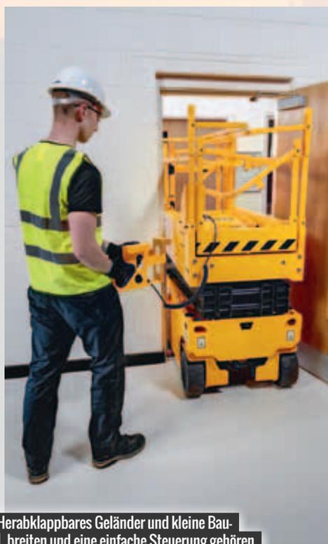
Herabklappbares Geländer und kleine Bauweiten und eine einfache Steuerung gehören mit zu den Standards von JCB
