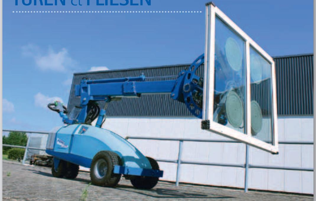
Das Unternehmen Aero-Lift produziert das Glashebergerät der Marke Clad-Lift. Unter ihren Kunden finden sich nicht nur Nutzer aus der Fassadenbaubranche. So nutzt ein Tunnelbauer die Geräte für den Einbau seiner Brandschutztüren. Die Elemente werden mit dem Gerät in den Tunnel trans-
