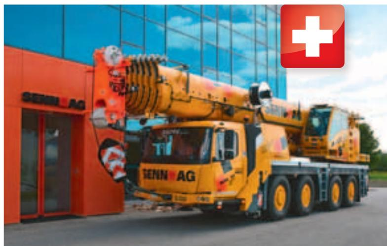
Der jüngste Neuzugang bei der Senn AG: ein Grove GMK 4100L-1. Verglichen mit dem Vorgängermodell verbessert der neue Kran bei Konfiguration mit maximal 26,2 Tonnen Gegengewicht seine Traglasten um insgesamt sieben Prozent. In der Taxi-Konfiguration mit 6,7 Tonnen Gegengewicht kann der GMK4100L-1 seine Leistung um neun Prozent gegenüber dem Vorgänger steigern.
