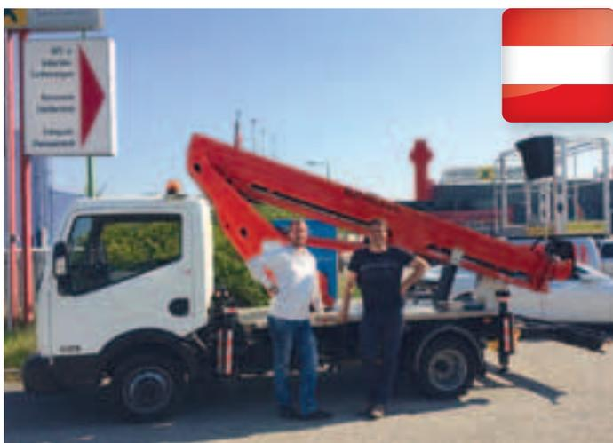
Eine neue Ruthmann Ecoline 180 hat dieser Tage die EWW AG erhalten. Das Unternehmen mit Sitz in Wels ist im Bereich Kommunaltechnik angesiedelt. Neben 18 Metern Arbeitshöhe bietet die LKW-Bühne eine Reichweite von 9,2 Metern und eine maximale Korblast von 250 Kilogramm.
