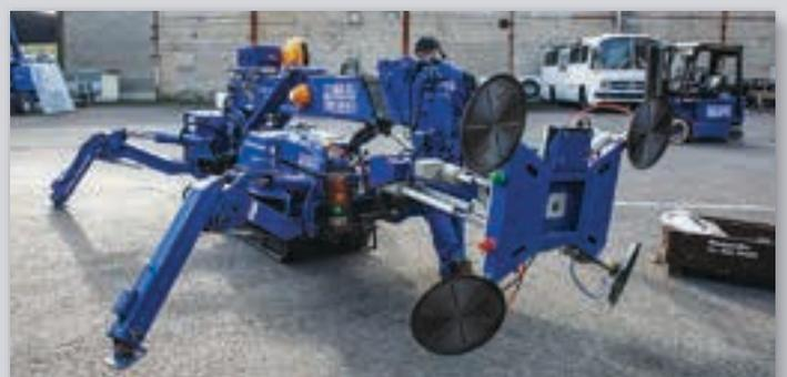
über integrierte Messgeräte. Diese überwachen sowohl das Vakuum als auch die Energieversorgung des Glassaugerrotors. Zusätzlich werden Abweichungen vom Soll-Zustand durch
