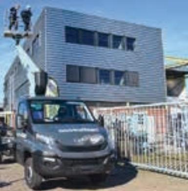
Der niederländische Vermieter Hoogwerkt erweitert seinen Fuhrpark um LKW-Arbeitsbühnen von Socage. Das Unternehmen hat 60 LKW-Bühnen geordert, um alle seine Standorte damit einzudecken. Zu den ersten gelieferten Geräten gehört die 21DJ. Diese bietet eine Reichweite von zehn Metern bei einer uneingeschränkten Kapazität von 225 Kilogramm oder von 8,7 Metern bei einer maximalen Korb-
