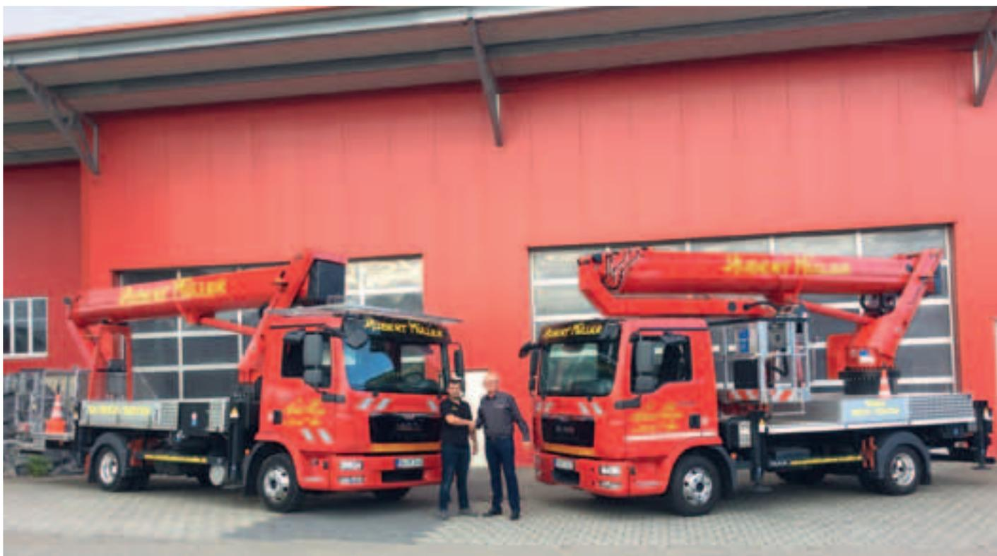
Hubert Müller aus Memmingerberg hat sich erstmals Ruthmann-Bühnen zugelegt: einen T330 und einen TU285. Die auf 7,5-Tonner aufgebauten Bühnen bieten 33 bzw. 28,5 Meter Arbeitshöhe und etwas mehr als 20 Meter Reichweite. <<
