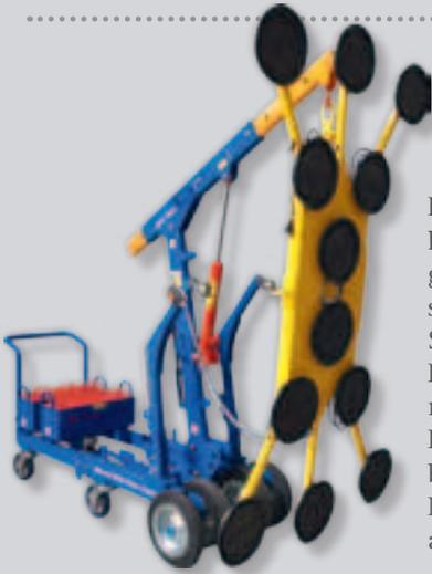
Der Wienold MFC ist ein handlicher Minikran mit 900 Kilogramm Tragkraft für kräfteschonendes Handling schwerer Scheiben, insbesondere über Hindernisse hinweg. Der manuelle Kran bringt ein in der Länge einstellbares Teleskop bis zu einer Auslage von 1,40 Meter über einen Hubzylinder auf 2,90 Meter Hakenhöhe.
