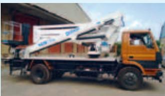
↑ Indiens internationaler Flughafen in Mumbai hat eine 29-Meter-LKW-Bühne vom Typ CTE Zed 29J erhalten. Aufgebaut auf einem Tata-Chassis, bietet das Gelenkteleskop 15,5 Meter Reichweite und 230 Kilogramm Tragkraft. Der Deal kam zustande über den indischen Vertriebspartner Gemini Power Hydraulics. Die Bühne soll in erster Linie für Wartungsarbeiten eingesetzt werden.
