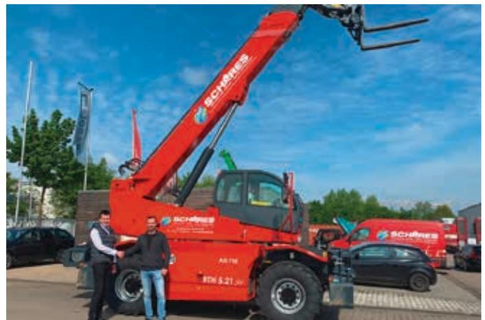
Schares Arbeitsbühnen aus Bocholt angelt sich zwei Teleskoplader von Magni: einen RTH 5.21 SH mit fünf Tonnen Tragkraft und 21 Meter Hubhöhe und einen RTH6.39 SH. Dieser hebt bis sechs Tonnen und bietet eine maximale Hubhöhe von 39 Metern – der höchste drehbare Teleskoplader mit hochfahrbarer und kippbarer Kabine am Markt. Schares erhält das Modell als erster Vermieter in Deutschland. <<
