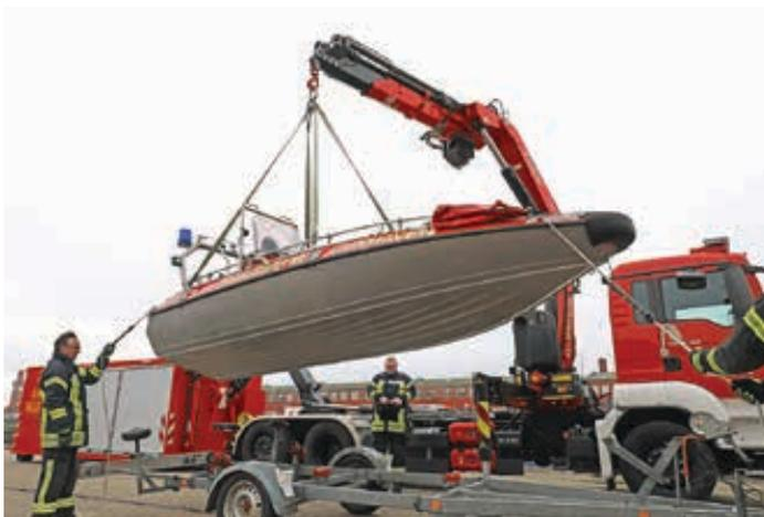
Die Berufsfeuerwehr von **Cuxhaven** jüngstes Einsatzfahrzeug ist ausgestattet mit einem Fassí F245A.025. Aufgebaut auf einem MAN TGS 26.400 wird das Fahrzeug unter anderem beim sogenannten Wattrettungszug eingesetzt. Dessen Aufgabe ist unter anderem ein Bootseklar zu machen, um Menschen in Not aus dem Watt zu retten. <<
