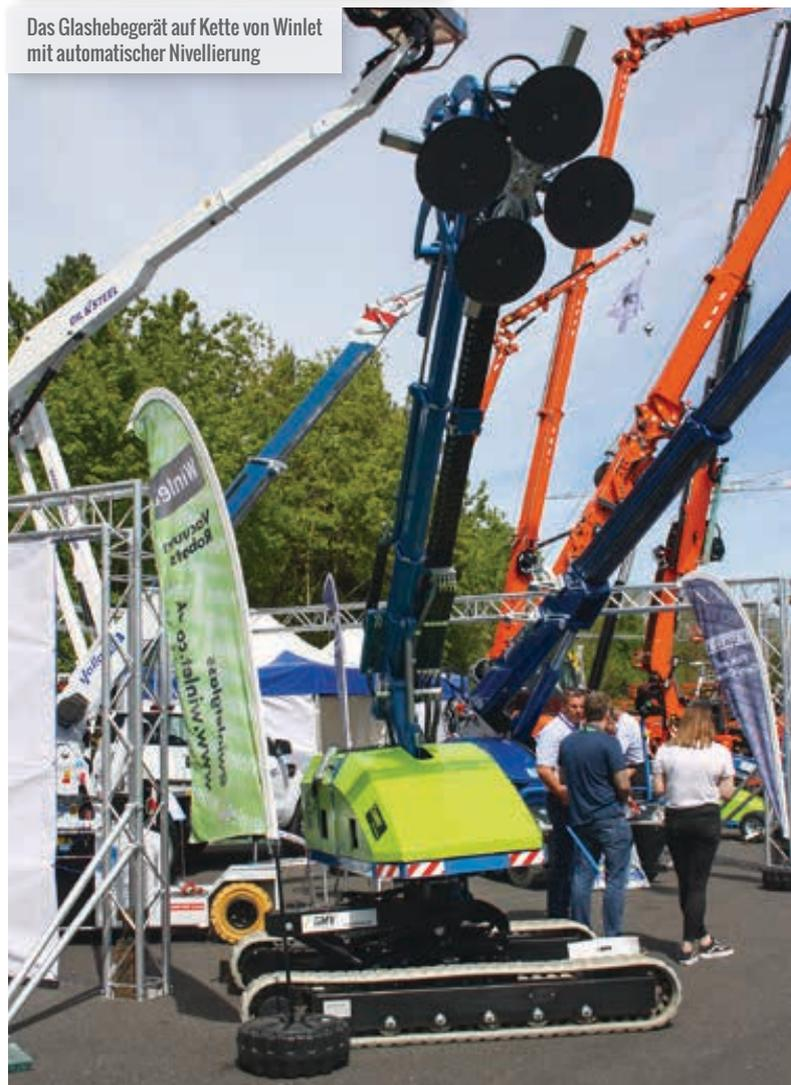
Das Glashebergerät auf Kette von Winlet mit automatischer Nivellierung
