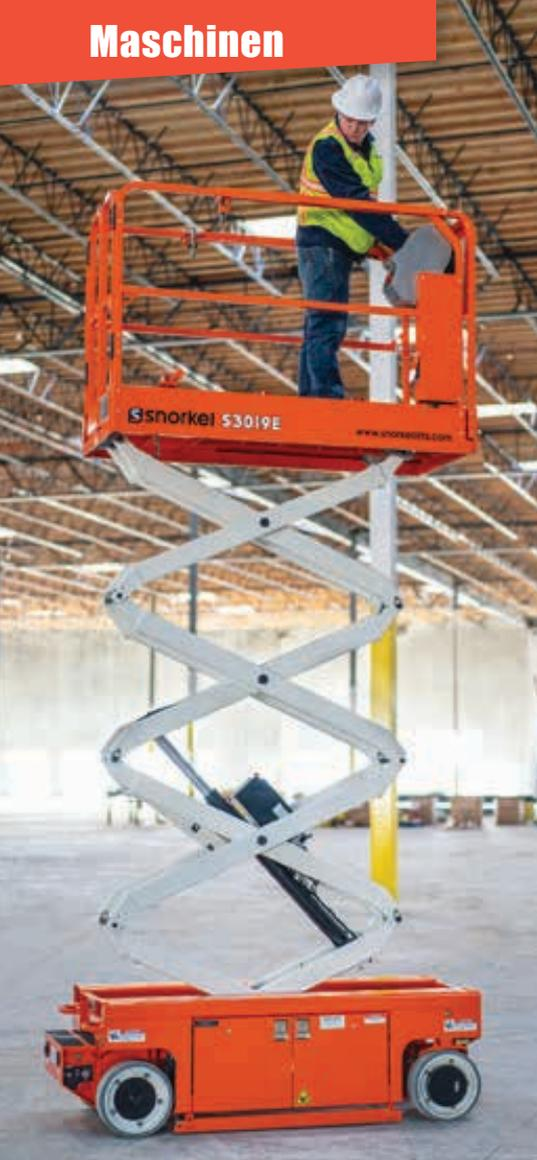
Clou an Snorkels S3019E: Das Scherenpaket versinkt eingefahren vollends im Chassis
