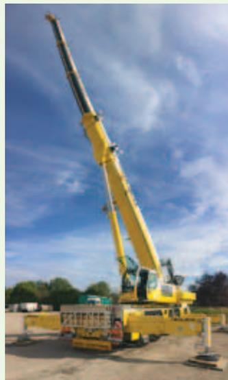
neue 4-Achs-AT kann wahlweise mit 10 Tonnen, 12 Tonnen und 16 Tonnen Achslast verfahren werden. Er bietet einen 60 Meter langen Teleskopausleger, zehn Meter mehr als das Vorgängermodell LTM 1090-4.1. BMS wird den neuen Kran in der Niederlassung Århus betreiben. Geschäftsführer Per Thorsen Christiansen sagt: „Als mir vor einigen Monaten das Konzept und die technischen Highlights des LTM 1090-4.2 erklärt wurden, wollte ich unbedingt gleich den ersten Kran dieses neuen Modells haben.“ ↓
