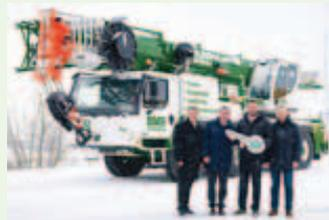
→ Als erster auf den Britischen Inseln hat sich der englische Vermieter **Spot Hire** eine **Palfinger P370 KS** zugelegt. Die LKW-Bühne bietet neben 37 Metern Arbeitshöhe eine Reichweite von bis zu 31,5 Metern, ist dabei aber in eingefahrenem Zustand lediglich 8,35 Meter lang. Die Bühne erlaubt eine maximale Korblast von 500 Kilo-
