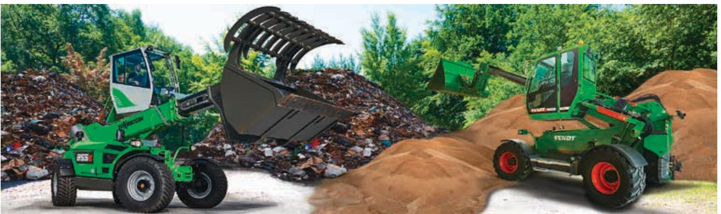
AGCO/Fendt bringt Sennebogens Teleskopklader in die Landwirtschaft. Gemeint ist das Modell 355 E mit einer Hubhöhe bis zu 8,5 Metern und einer Traglast von maximal 5,5 Tonnen. Die Maschine wird als Fendt Cargo T955 vermarktet. Die Kooperation beider Firmen versetzt Fendt in die Lage, die Teleskopklader unter eigenem Markennamen in der Agrarbranche zu vertreiben und den kompletten After-Sales-Service selbst zu übernehmen. Künftig sollen weitere Modelle hinzukommen. <<
