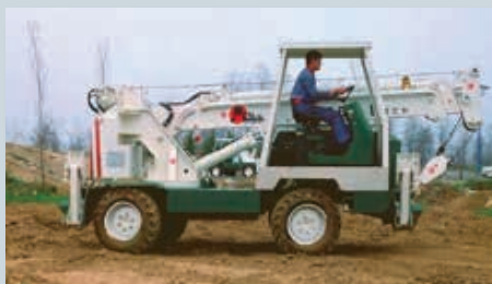
1974 entwickelte Merlo das erste Kranmodell mit Abstützungen und einem dreh- und ausfahrbaren Kranarm
