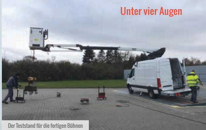
Der Teststand für die fertigen Bühnen
