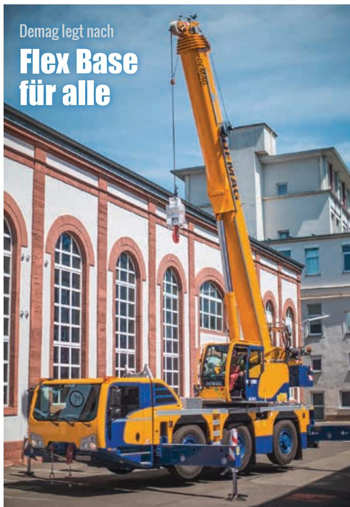
Demag stattet nach dem AC 45 City nun auch die All-Terrain-Krane AC 55-3 und AC 60-3 mit seiner stufenlos ausfahrbaren Abstützung „Flex Base“ aus. Auslöser hierfür waren die positiven Rückmeldungen der Kunden, so der Konzern. Außerdem sei man stets bestrebt, die Modelle leistungsfähiger zu machen. Dank Flex Base können die Krane ihre Abstützungen an jeden Punkt innerhalb des verfügbaren Bereichs heranfahren – also direkt
