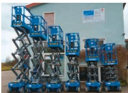
Gleich ein Sixpack von Genie-Scheren gab es für Schmid Hebebühnen aus Haimhausen. Das Paket besteht aus je zwei GS-1330m, GS-1532 und GS-1932. Sie wurden innerhalb eines Tages durch die Werkstatt in Betrieb genommen und stehen den Kunden ab sofort zur Verfügung. <<
