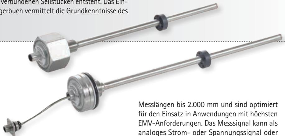
Messlängen bis 2.000 mm und sind optimiert für den Einsatz in Anwendungen mit höchsten EMV-Anforderungen. Das Messsignal kann als analoges Strom- oder Spannungssignal oder über Feldbuschnittstellen (CANopen, CAN SAE J1939) ausgegeben werden. Sie lassen sich per Steckverbindung einbauen – ganz ohne Löten, Crimpen oder Schrauben.
