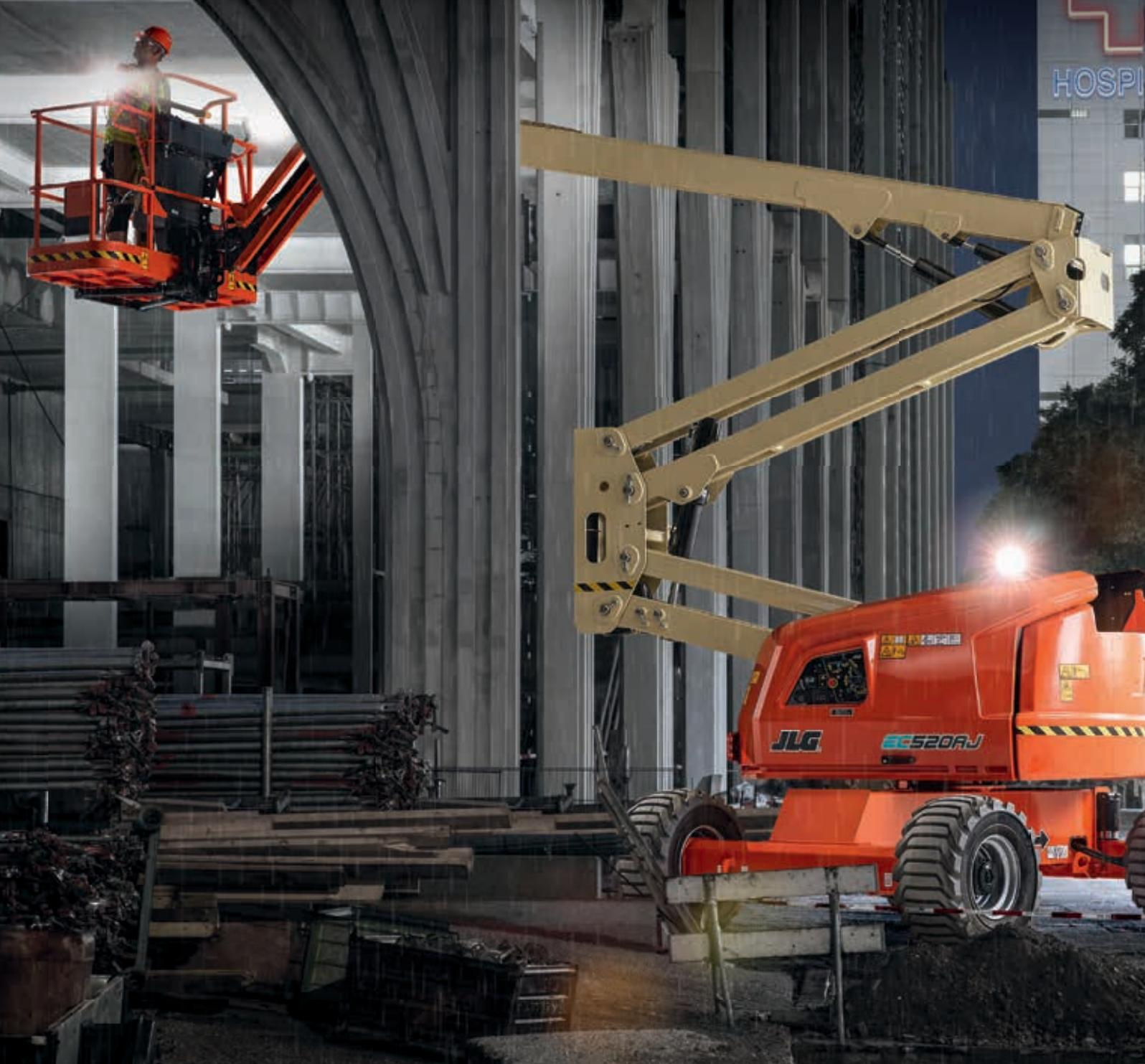
Ab sofort können Sie ohne Störung der Umgebung in sensiblen Bereichen arbeiten. Mit ihren sicheren, schnell ladenden Lithium-Ionen-Akkus und den beiden Elektromotoren bieten die elektrischen Arbeitsbühnen von JLG® einen sauberen Betrieb und eine höhere Energieeffizienz an jedem Arbeitsort. Erleben Sie kompromisslose Leistung in Verbindung mit der Flexibilität, im Innen- und Außenbereich mit derselben Maschine arbeiten zu können.
