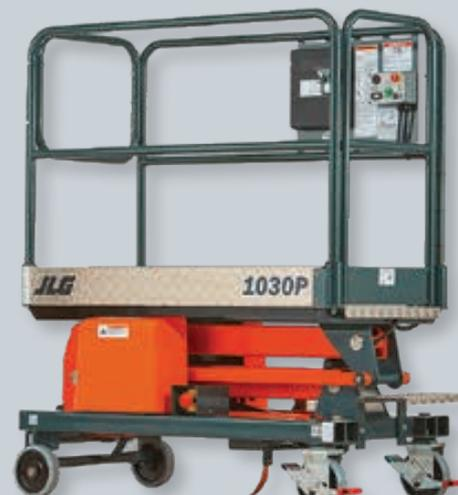
Einfach nur schieben und dennoch auf 5,1 Meter Arbeitshöhe hinauf, das geht auch mit der 1030P von JLG
