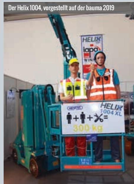
Mastbühnen für den Inneneinsatz mit Korbarm *Made in Germany* gibt es auch unter dem Markennamen **Helix**. Dabei wird das Segment von zehn bis 15 Meter Arbeitshöhe besetzt und somit werden die großen Höhen anvisiert. Die Geräte mit einer Breite von 0,98 beziehungsweise 1,20 Meter drehen innerhalb der Kontur und bieten eine Reichweite je nach Modell von bis zu fünf Meter.
