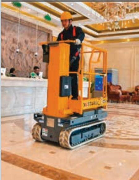
Mit direktelektrischem Antrieb ausgestattet: die TM16 von Snorkel
