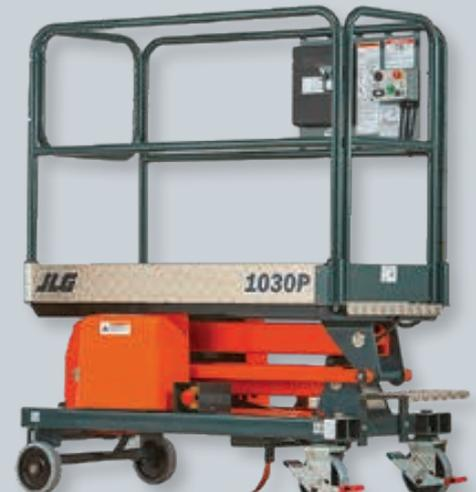
Einfach nur schieben und dennoch auf 5,1 Meter Arbeitshöhe hinauf, das geht auch mit der 1030P von JLG
