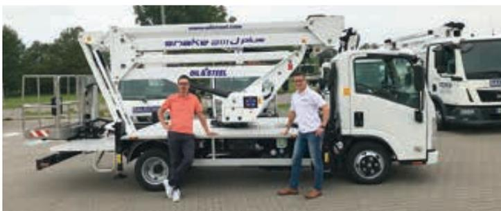
Die Firma für Werbetechnik Neon Wertz aus Dortmund hat eine LKW-Bühne mit 21 Meter Arbeitshöhe und elf Meter seitlicher Reichweite von Oil&Steel erhalten. Die Wahl fiel auf eine Snake 2111 J, ein Gelenkteleskop mit Korbarm und 250 Kilogramm Korblast. <<
