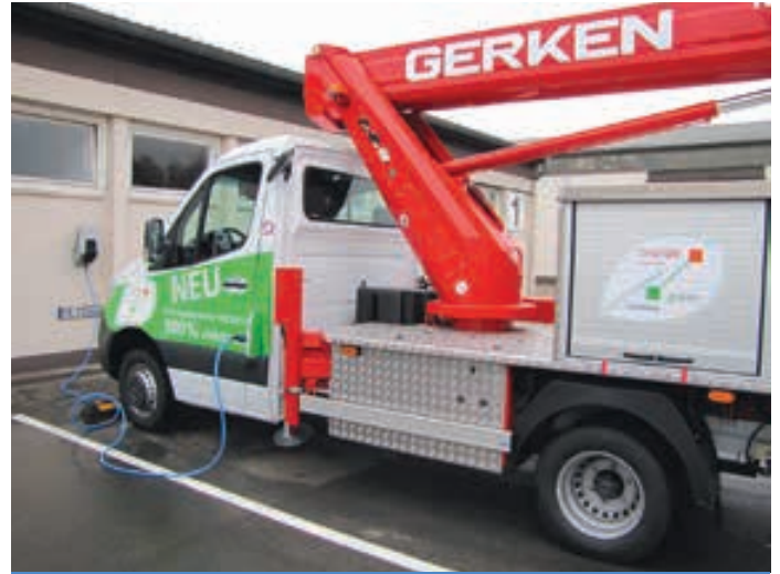
Den ersten Ampero TBR 250 E mit 24,5 Metern Arbeitshöhe wird Ruthmann auf der bauma zeigen. Die erste Maschine geht an Gerken. Von den Leistungsdaten und vom Funktionsumfang her ist die Neuheit identisch mit dem Dieselmodell TBR 250 HV5, wird aber komplett elektrisch betrieben. <<
