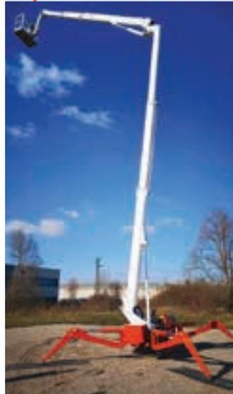
Gezeigt wird die neue RA31HY Raupenarbeitsbühne. Das Gerät ist mit Hybridantrieb ausgestattet, bei dem das Unternehmen zum Dieselmotor einen Elektromotor, angetrieben durch Lithium-Ionen-Batterien, ausstellt. Zum Grundpaket gehören eine separate Fernsteuerung und eine verbreiterbare Spur.
