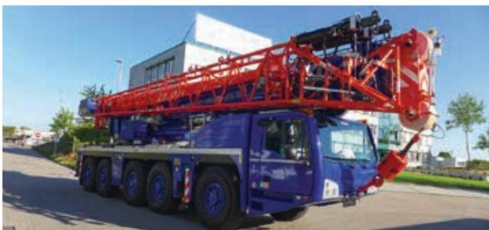
» Das Schweizer Unternehmen Norline hat sich für einen neuen All-Terrain-Kran vom Typ Demag AC 160-5 entschieden. Vor allem der mit 68 Metern längste Hauptausleger dieser Klasse überzeugte das Spezialunternehmen für Bautechnik, Stahlbau und Erdsondenbohrungen. Ausgeliefert wurde der Kran in der Konfiguration mit hydraulisch abwinkelbarer Doppelklappspitze.
