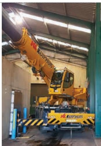
4,5 Tonnen schweres Gärrest-Sieb für die Kompostierung ausgetauscht werden. Aufgrund extrem knapper Platzverhältnisse konnten die Abstützungen auf einer Seite gar nicht und auf der anderen Seite nur zu 25 Prozent ausgefahren werden. Selbst der Teleskopausleger hatte nach oben und unten nur minimale Bewegungsfreiheit. <<
