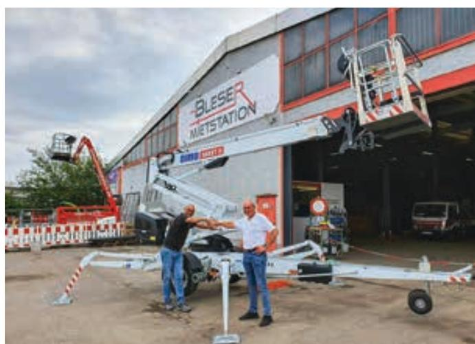
**Bleser aus Neuwied** hat seine erste **Dino-Anhängerbühne** erhalten. Es handelt sich um eine **Dino 180XT II** mit 18 Metern Arbeitshöhe, 11,20 Meter seitlicher Reichweite und maximal 215 Kilogramm Korblast. <<
