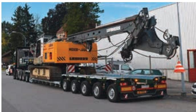
>> Erneut hat sich die Emil Egger AG mit einem Auflieger von Faymonville verstärkt, diesmal für den Transport schwerer Baumaschinen mit maximal 84 Tonnen Nutzlast. Die Wahl fiel auf einen 2+5 Gigamax-Tiefbettauflieger, der fortan mit einer 8x4 Sattelzugmaschine zum Einsatz kommt. Hier an Bord: ein Bohrgerät Liebherr LB24.
