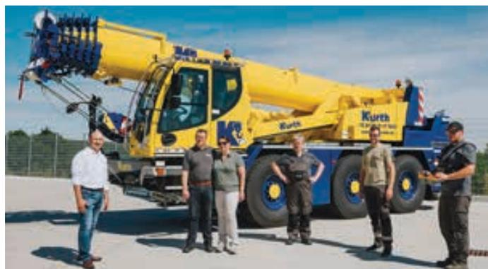
**Kurth Autokrane** hat sich einen **Liebherr-Kompaktkran LTC 1050-3.1** mit 50 Tonnen Traglast zugelegt, gedacht für schwierige Einsätze in beengten Arbeitsumgebungen. Das entscheidende Feature ist die Funkfernsteuerung **Remote Drive**. Damit lässt sich sogar der Kranunterwagen steuern. <<
