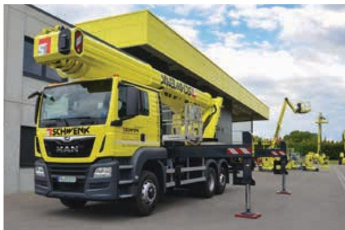
Neues Flaggschiff: Die Firma Schwenk Arbeitsbühnen erweitert ihren Mietpark um einen Ruthmann-„Steiger“ T 510 HF mit DRS, welches die Bühnenperformance durch On-Board-Reichweitenberechnung in Echtzeit maximiert. Mit 51 Metern Arbeitshöhe stößt Schwenk in eine neue Dimension vor. <<
