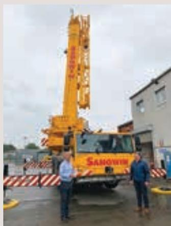
↑ Das britische Vermietunternehmen **Sangwin Plant Hire** hat den ersten Tadano ATF 100-4.1 in England in Empfang genommen. Geordert wurde er mit einer 18 Meter langen Auslegerverlängerung, 30,4 Tonnen Gegengewicht und einem AMOT Kraftstoff-Absperrentil, sodass der mit zwei Motoren ausgestattete Kran gut in der Chemie-, Öl- und Gasindustrie eingesetzt werden kann.
