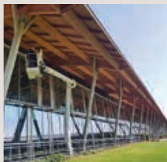
↑ Zwei Eurosky-Bühnen mit Doppelgelenk dienten als Ausgangsbasis für zwei sehr besondere Bühnen, die **Comet** bei seiner Tochterfirma X Trux in Perugia speziell für den Fitness- und Sportgerätehersteller Technogym konstruiert hat. Mit einer Arbeitshöhe von 25 Metern und einer seitlichen Reichweite von 13 Metern sowie einer maximalen Korblast von 200 Kilo-
