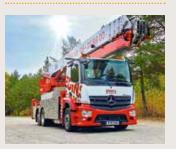
↑ Der schwedische Kranvermieter Edins Kranar hat den ersten Klaas-Autokran K1003 im Land von Kranlyft übernommen. Der K1003 ist auf einem 3-achsigen Mercedes Actros 2530 mit lenkbarer Hinterachse montiert und verfügt über einen vierteiligen 31
