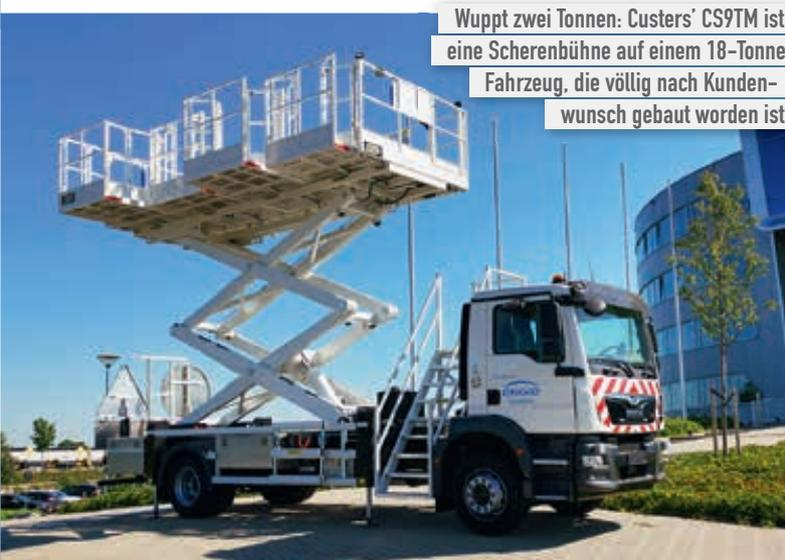
Wuppt zwei Tonnen: Custers' CS9TM ist eine Scherenbühne auf einem 18-Tonnen-Fahrzeug, die völlig nach Kundenwunsch gebaut worden ist
