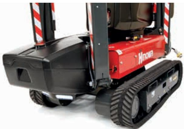
BEHÄLTER FÜR UNTERLEGPLATTEN
