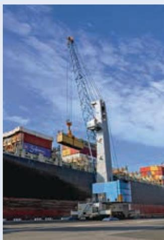
↑ Für den neuen Westhafen im dänischen Kalundborg hat der dortige Hafen einen *Modell 7*-Ha- fenmobilkran Variante G HMK 7608 von **Konecranes** geordert. Mit bis zu 54 Meter Arbeitsradius und einer Traglast von maximal 150 Tonnen kann er an Container- schiffen bis zur Super-Post-Pa- namax Klasse eingesetzt werden. Der Kran wird von **APM Terminals** betrieben werden, zu dessen Standorten Kalundborg seit Kur- zem zählt. „Wir bereiten derzeit unsere neuen Liegeplätze für die
