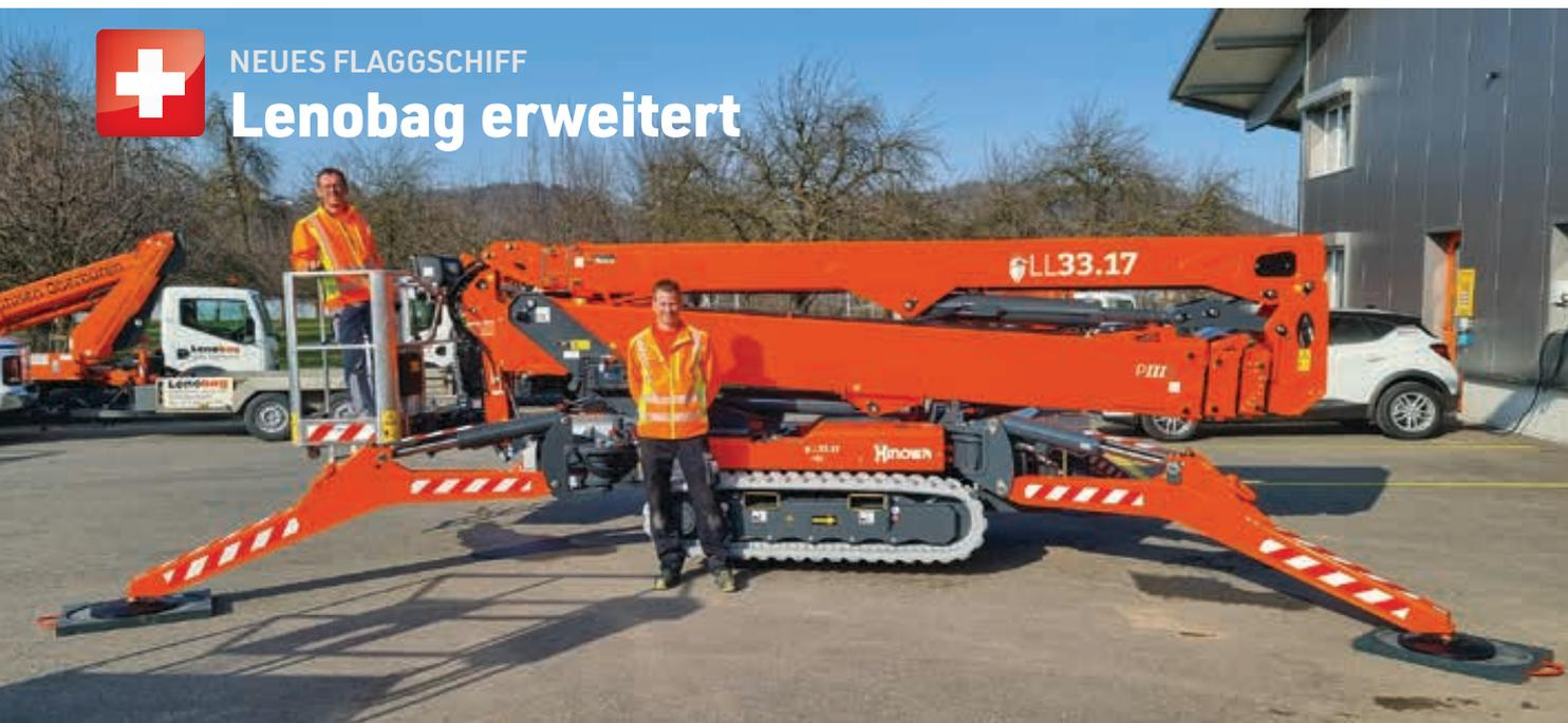
Die Lenobag AG mit Sitz in Oberbüren im Kanton St. Gallen erweitert ihren Mietpark nach oben hin mit einer Raupenbühne vom Typ Lightlift 33.17 IIS Performance in Bi-Energy-Ausführung von Hinowa. Diese kombiniert einen Kubota-Diesel- mit einem 380-Volt-Elektromotor. „Der Neuzugang der Raupenarbeitsbühne Lightlift 33.17 IIS Perfor-
