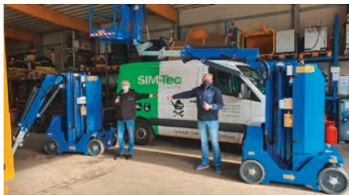
→ Ihre ersten zwei Helix 1205-Teleskopmastbühnen hat die Firma Sim-Tec aus Kirchberg erhalten. Das batteriebetriebene Modell bietet zwölf Meter Arbeitshöhe und 5,15 Meter Reichweite sowie 200 Kilogramm Korblast.
