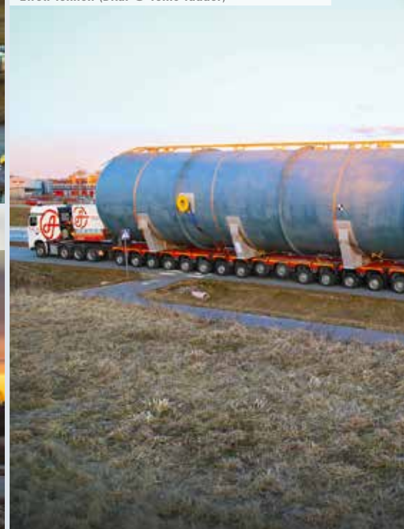
26 Achslinien verteilen die Last: auf jeder Achse zwölf Tonnen (Bild: © Tõnis Tuuder)
