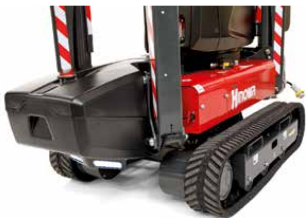
BEHÄLTER FÜR UNTERLEGPLATTEN LED-SCHWEINWERFER VORNE UND HINTEN
