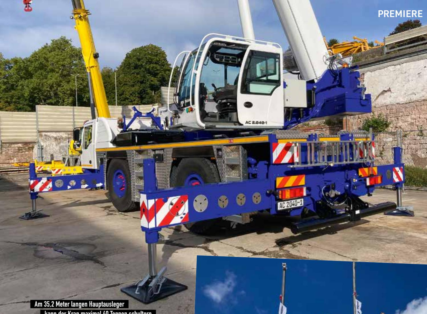
Am 35,2 Meter langen Hauptausleger kann der Kran maximal 40 Tonnen schultern
