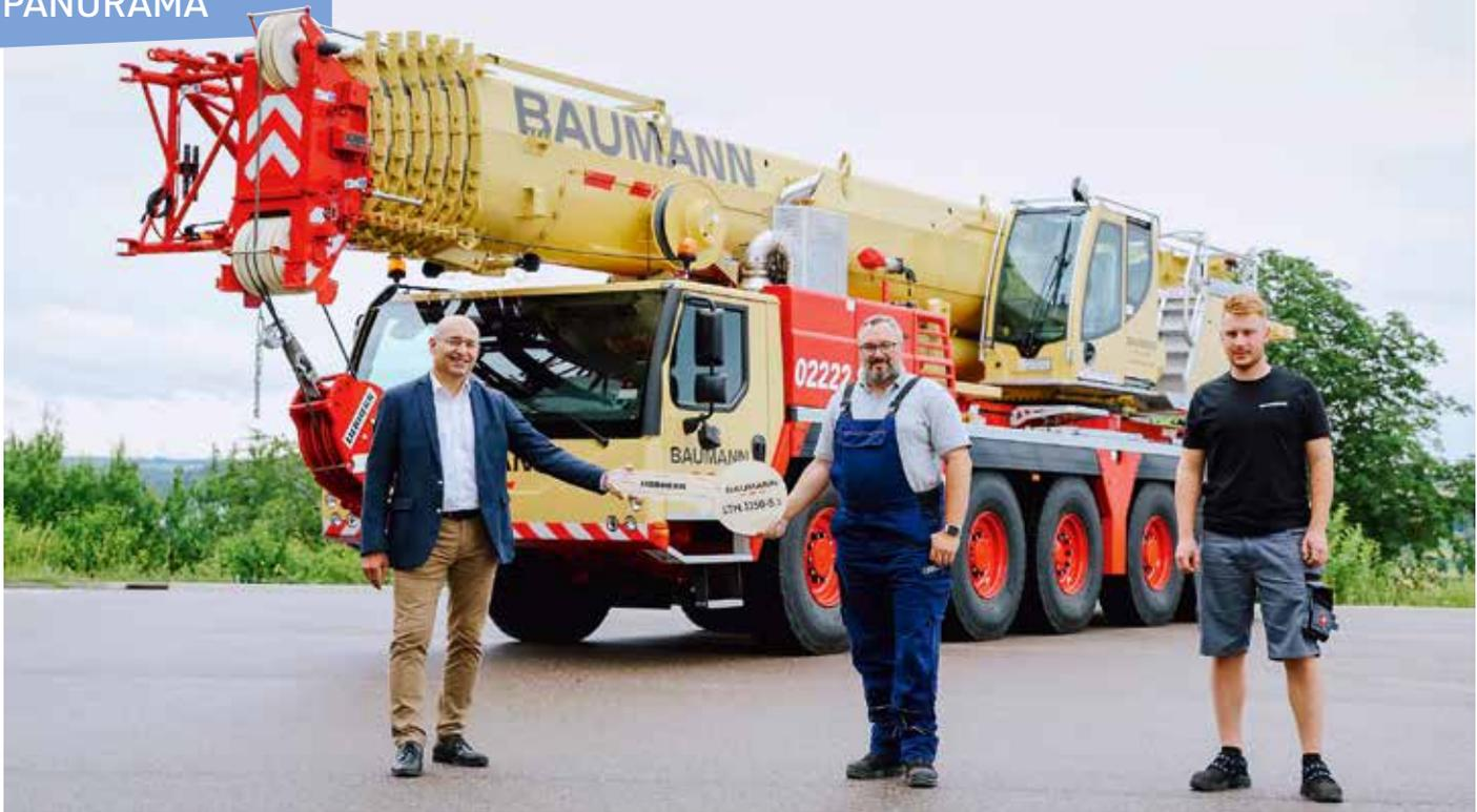
→ Der Kranvermieter Viktor Baumann schließt mit einem neuen Liebherr LTM 1150-5.3 die Lücke zwischen 130 und 200 Tonnen. Der Teleskopausleger bietet im Vergleich zum Vorgänger ein Plus von sechs Metern Länge. Spezialgebiet: Montage von Turmdrehkränen und Funkmasten.
