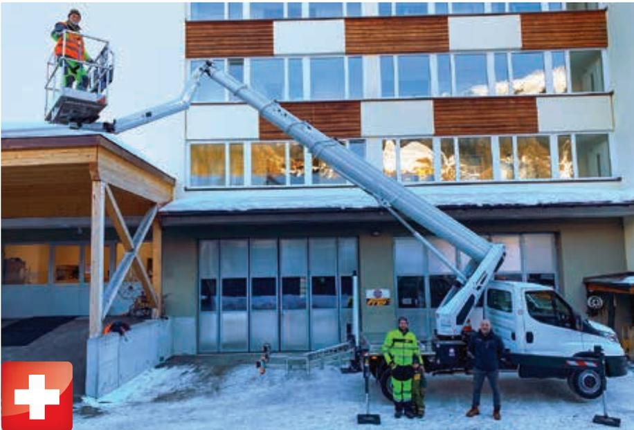
↑ Die auf Transporte und Kranarbeiten spezialisierte Frei Transporte Davos AG hat ihren Maschinenpark um eine neue LKW-Bühne erweitert. Die Wahl fiel auf einen Ruthmann „Steiger“ TBR 260 mit 26 Meter Arbeitshöhe und bis zu 17 Meter Reichweite.
