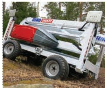
In der vergangenen Ausgabe haben wir über die Rhino RXT 280 von Dinolift berichtet und von einer Reichweite von 11,0 Metern berichtet. Die selbstfahrende Gelenkteleskopbühne hat eine maximale Reichweite von 16 Metern bei einer Korblast von 120 Kilogramm und 14 Metern bei einer Korblast von 230 Kilogramm. ■
