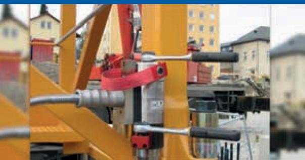
Schraubenspannzylinder Eckstielverschraubung M45
