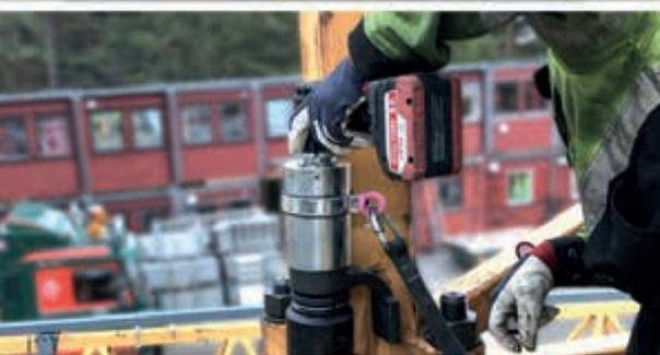
Drehschrauber ADS 600 Eckstielverbindung M45, M<sub>A</sub> = 5.850 Nm
