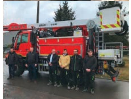
↑ Elektroanlagenbauer MEAB Meyer aus Pöbneck hat sich eine neue Versalift-Offroadbühne VO-355-MHI zugelegt, die gegen 69kV isoliert und auf einem 16,5 Tonnen schweren Unimog U-527L Allrad-Chassis aufgebaut ist. Nach 17 Jahren war es an der Zeit, das alte Fabrikat von 2005 zu ersetzen.
