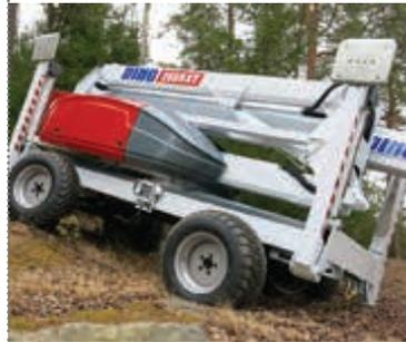
In der vergangenen Ausgabe haben wir über die Rhino RXT 280 von Dinolift berichtet und von einer Reichweite von 11,0 Metern berichtet. Die selbstfahrende Gelenkteleskopbühne hat eine maximale Reichweite von 16 Metern bei einer Korblast von 120 Kilogramm und 14 Metern bei einer Korblast von 230 Kilogramm. ■
