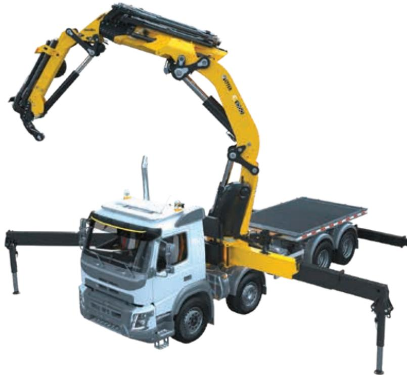
Das patentierte „CrosStab“-Stützbeinsystem ist jetzt auch für den Ladekran Effer 1000 von Hiab zu haben. Das System, von Effer entwickelt und 2010 auf den Markt gekommen, erhöht die vertikale Hubkapazität und verbessert die Einsatzmöglichkeiten auf engstem Raum. Ab Juli 2022 kann es als Zusatzausstattung für Effer-1000-Ladekrane mitbestellt werden.
