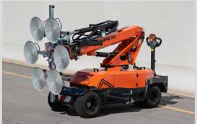
Zu sehen war er bereits. Jetzt kommen mehr Details des neuen MPK10 von Jekko. Das Glashebegerät mit 990 Kilogramm Tragkraft ist mit vier 24Volt-Batterien ausgestattet, die eine Leistung von 155Ah bringen. Das vollelektrische Gerät wiegt selbst 970 Kilogramm und kann noch weitere Gegengewichte schultern. Dank des niedrigeren Gewichts, lässt sich das Gerät auch auf einen kleinen Anhänger transportieren. <<<
