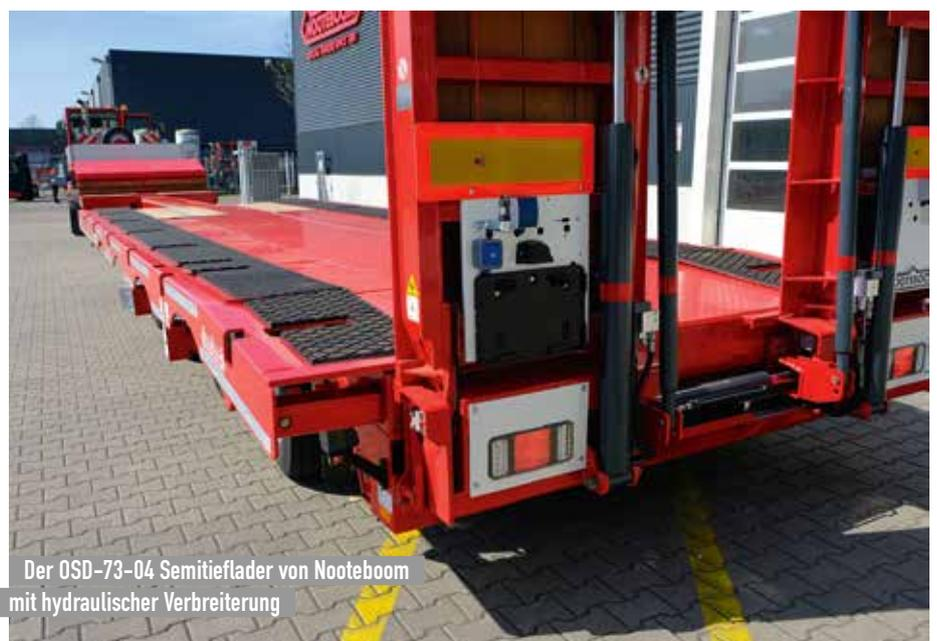
Der OSD-73-04 Semitiefelader von Nootboom mit hydraulischer Verbreiterung
