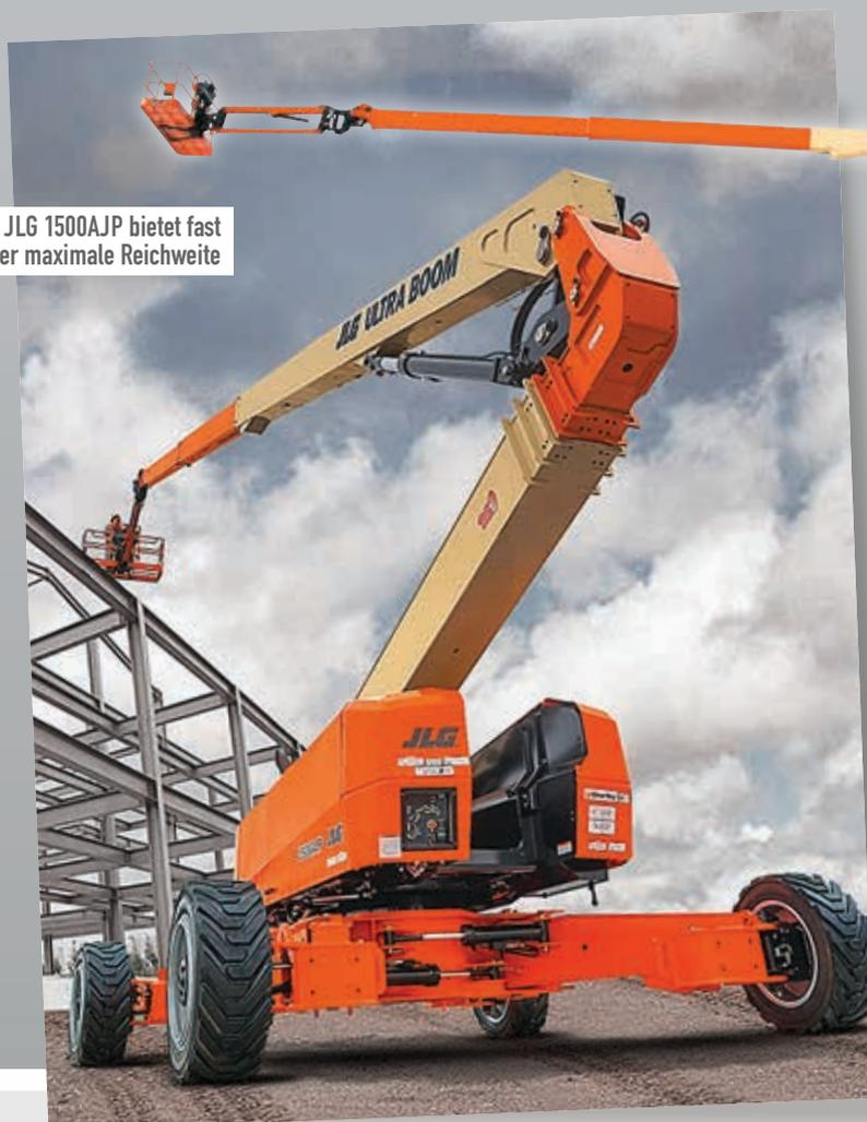
Die JLG 1500AJP bietet fast 23 Meter maximale Reichweite
