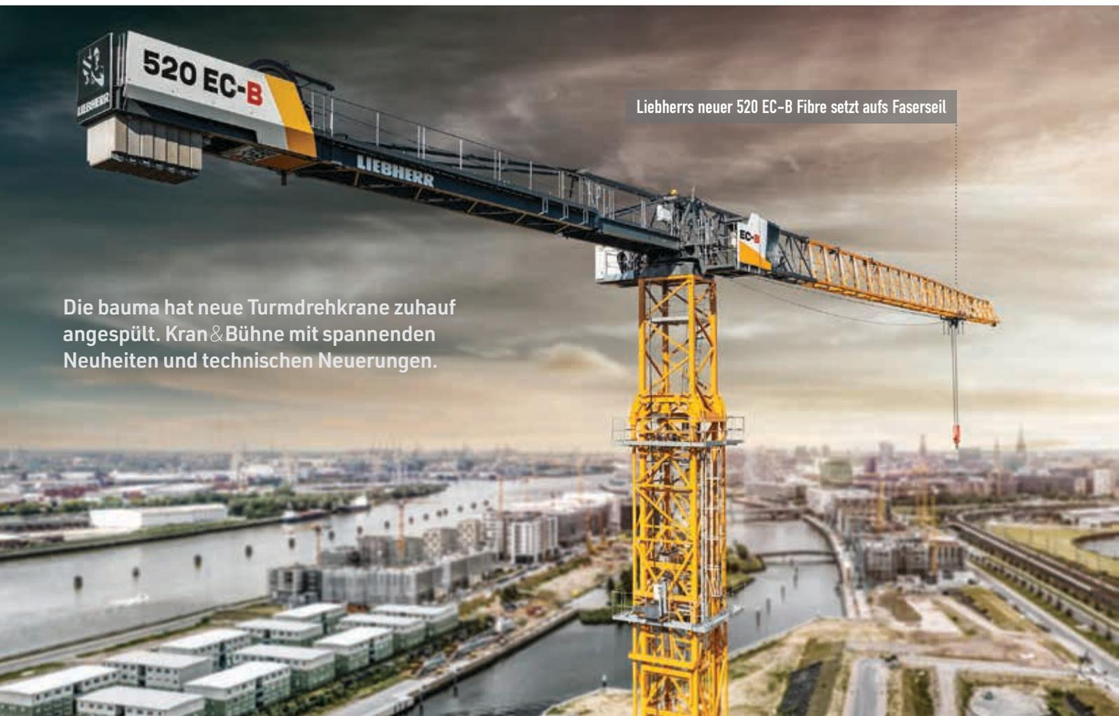
Liebherr's neuer 520 EC-B Fibre setzt aufs Faserseil
