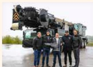
Einen neuen **Spierings SK1265 AT6 E-Lift-Turmdrehkran** hat das britische Vermietunternehmen **Sparrow Crane Hire** übernommen. Der Kran hat eine maximale Tragfähigkeit von zehn Tonnen, die er in einem Radius von mehr als 13 Metern bewegen kann. Sein 60 Meter langer Ausleger hat eine Spitzentraglast von 1.700 Kilogramm. Das E-Lift-System ermöglicht den Anschluss an eine
