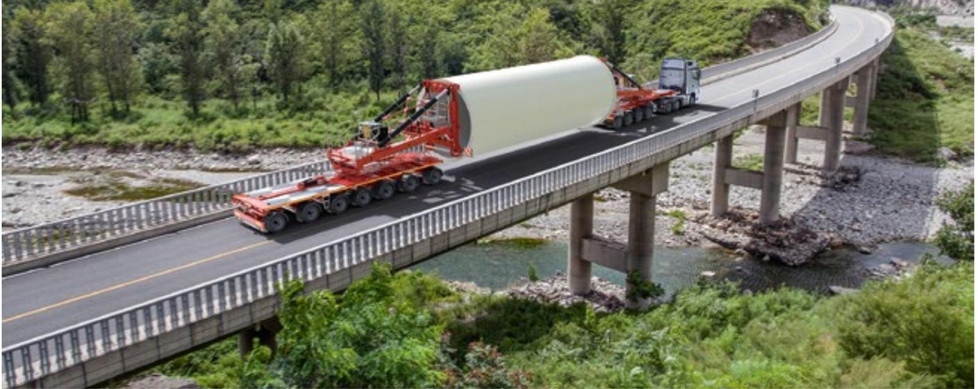
Einen neuen Satz Anhängeradapter mit Standardrotator für den Transport von Turmsektionen von Windkraftanlagen hat Faymonville vorgestellt. Das Bauteil, aufgesattelt auf einer 4+7 Nachläuferkombination, fülle im Sortiment eine letzte Lücke, wie es heißt. Das Fahrzeug basiert vorne auf einem luftgefederten 4-Achs-Dolly, das für 6x4 und 8x4 oder 8x4 und 10x4 Sattelzugmaschinen ausgelegt werden kann. Es ist für den Transport
