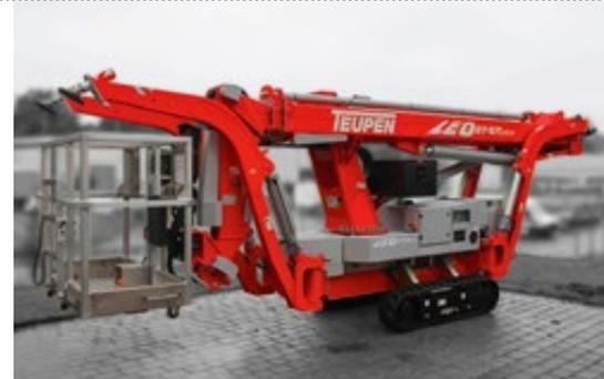
mit einem neuen Farbdisplay im Arbeitskorb, der neuen Fuzzy V-Steuerung sowie einer breiteren und längeren nicht-markierenden Gummikette ausgestattet.
