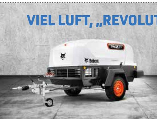
Nichts Geringeres als den „vielseitigsten mobilen Kompressor der Branche“ bringt Bobcat auf den Markt. Der PA12.7v ist ein Luftkompressor mit variablem Druck. Dank des Systems Flex Air-Technologie kann er im Bereich von 5,5 bis 12,1 bar und einer Luftliefermenge von 5,2 bis 7 m<sup>3</sup>/min arbeiten. Die Druckluftleistung lässt sich mit einem einfachen Tas-
