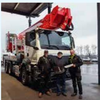
↑ Das italienische Vermietunternehmen **Gianfranco Savani** hat eine LKW-Arbeitsbühne vom Typ **Multitel MJ375** mit 37,5 Metern Arbeitshöhe erhalten. Montiert ist sie auf einem dreiachsigen 18-Tonnen-Chassis von MAN. Ausgestattet ist die Bühne zudem mit einer 700 Kilogramm starken Winde. Das Unternehmen hat außerdem eine 60-Meter-Bühne **MJ600** bei Multitel bestellt, die im November dieses Jahres ausgeliefert werden soll.
