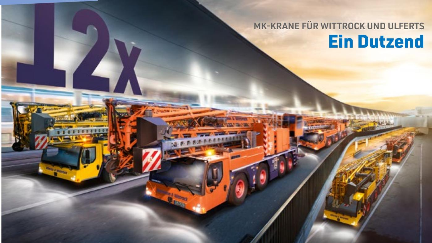
Der Firmenverbund Wittrock und Ulferts ordert zwölf Mobilbaukrane. Die neun MK 88-4.1 und drei MK 140-5.1 werden zwischen Oktober 2024 und Juli 2025 an unterschiedliche Standorte in Deutschland ausgeliefert. Der vierachsige Mobilbaukran MK 88-4.1 bietet eine maximale Reichweite von 45 Metern, der fünfachsiges MK 140-5.1 kommt mit Vario Jib auf eine maximale Reichweite von 65 Metern und Hakenhöhen bis zu 92 Metern.
