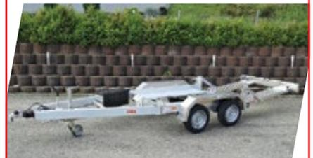
über 3.000 kg Nutzlast bei 3,5t zGG
